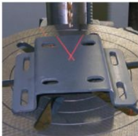
Sistema de láser para el centrado de la broca
