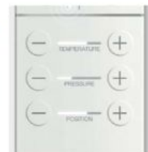
Индивидуални настройки за температура и сила на водната струя, позиция на канюлата
