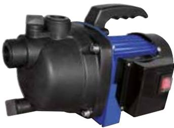
146246 Potencia 600 W. Autoaspirante a 7m. Cable de 1,2 m, lista para usar altura máx 3 5 m caudal max 3000 L/h. Cuerpo en tecnopolímero, salida 1". Ø máx de partículas 0,5 mm.
